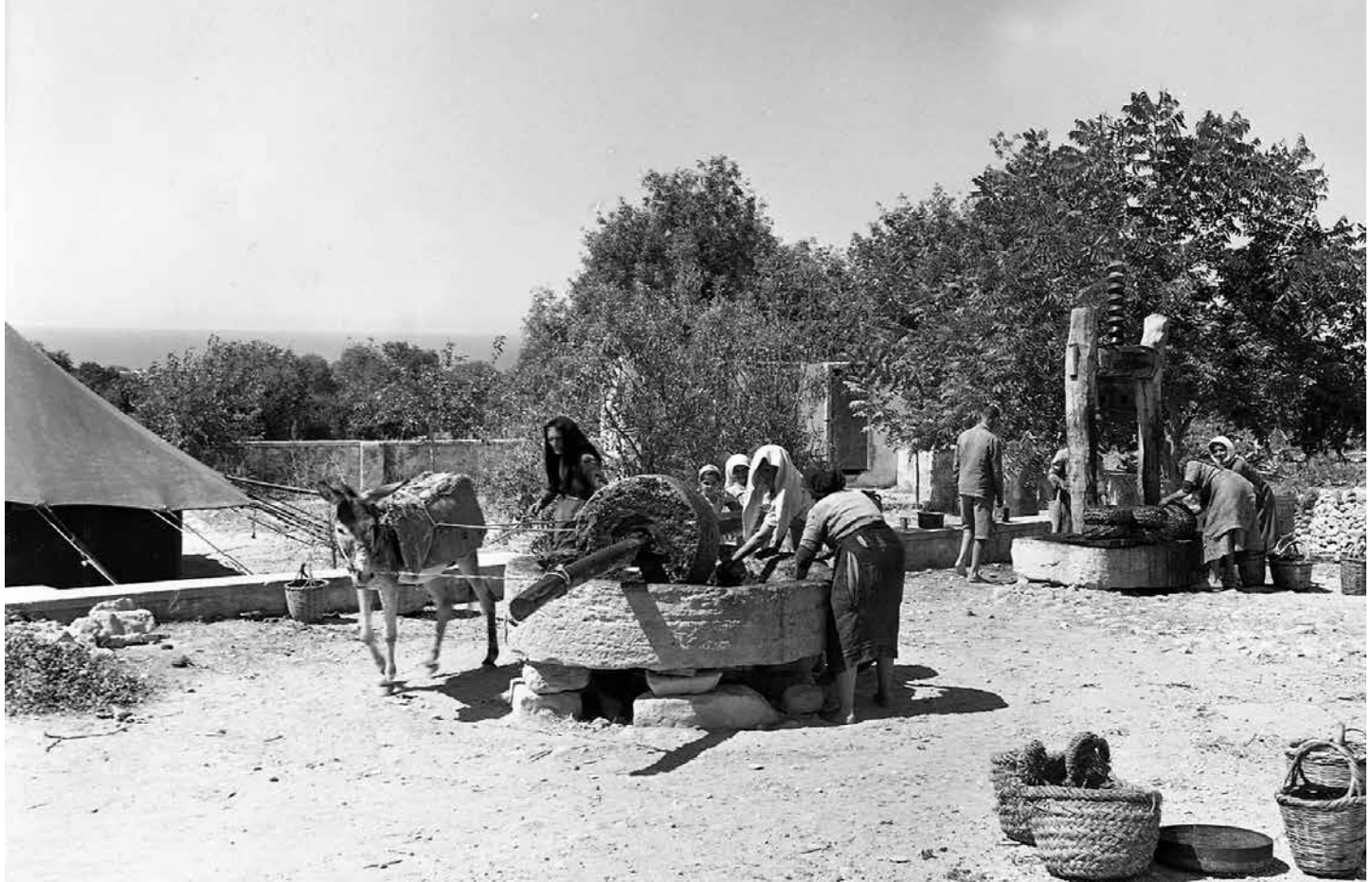
Υπαίθριο ελαιοτριβείο στην Πάφο, του οποίου οι μιλόπετρες κινούνται περιστροφικά με τη δύναμη του γαϊδουριού.
